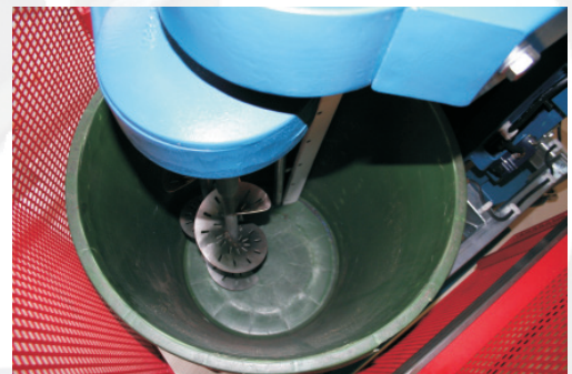
B 200 mit Abstreifereinrichtung im konischen Fass
